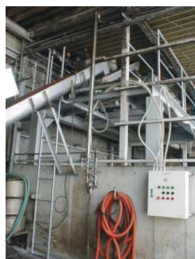
デカンターから スクリュコンベアで 乾燥機へ投入
