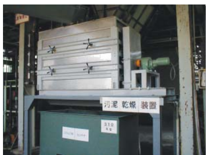
乾燥した 汚泥を下の ホッパーに 貯留
