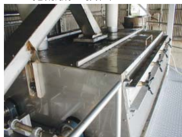
デカンターから スクリュコンベアで 乾燥機へ投入
